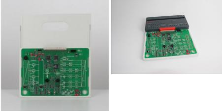
Cours sur les notions de base et les applications des procédés de modulation numérique, constitué d'une carte d'expérimentation avec différents circuits à utiliser avec l'unité centrale.
