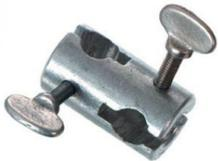
Pour assembler des tiges et des tubes. En emmanchant l'un dans l'autre des tubes de diamètre approprié (tubes de 10 mm dans tubes de 13 mm), la noix universelle permet un ajustage en hauteur sans à-coups de dispositifs fixés.
