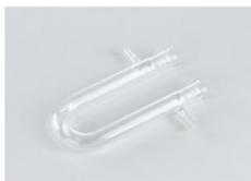
Pour l'électrolyse et le séchage des gaz
