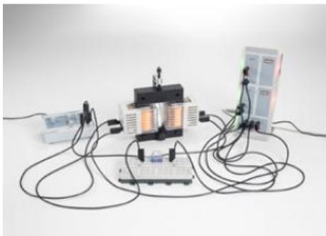
Dans l'expérience P7.3.2.1, un courant  $I_1$  augmentant (ou diminuant) linéairement avec le temps, génère l'intensité de champ magnétique
