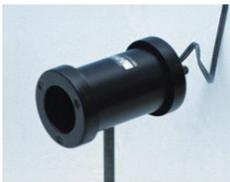
Source lumineuse multi-usages avec tube coulissant dans l'axe et trois vis moletées permettant de centrer le culot de lampe ; sur tige support.
