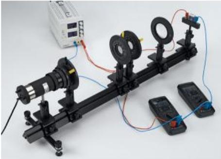
Le but de l'expérience P7.2.3.1 est l'étude d'une part, de la relation entre le courant photoélectrique  $I_{Ph}$  et la tension  $U$  pour une intensité de rayonnement  $e$  constante et, d'autre part, de la relation entre  $I_{Ph}$  et  $e$  pour une tension  $U$  constante.
