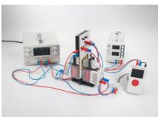
Dans les expériences P7.2.1.3 et P7.2.1.4 , on étudie la tension de Hall et la conductivité électrique en fonction de la température
