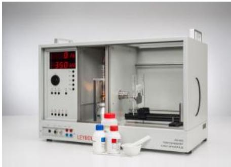
Dans l'expérience P7.1.2.3, des échantillons de fine poudre de cristal micro granulaire sont irradiés avec le rayonnement K $\alpha$  du molybdène afin d'obtenir un film photographique avec la méthode de Debye-Scherrer. Parmi les nombreux cristallites désordonnés, il y a toujours des rayonnements X qui présentent une orientation conforme à la condition de Bragg.
