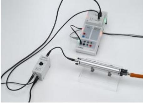
Durant l'expérience P6.5.4.4, on analyse les diverses contributions de la chaîne de désintégration du Ra-226 au spectre dénergie  $\alpha$ , pour déterminer l'âge de la préparation radioactive de Ra-226 utilisée. On obtient l'âge  $T$  de l'échantillon d'après la relation
