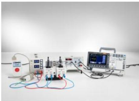
Durant l'expérience P6.5.3.1, on met en évidence la résonance de spin nucléaire du polystyrène, de la glycérine et du Téflon.
