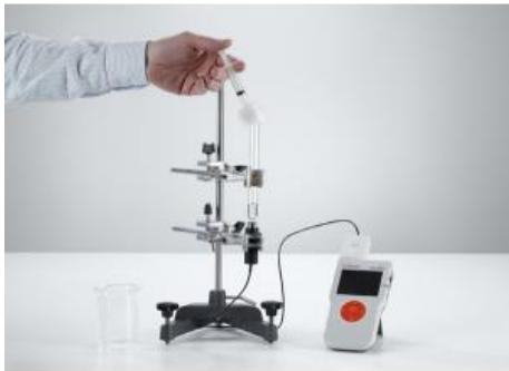
Pour déterminer la demi-vie du Ba-137m dans l'expérience P6.4.3.3, on utilise une bouteille en plastique contenant du Cs-137 conservé au sel.
