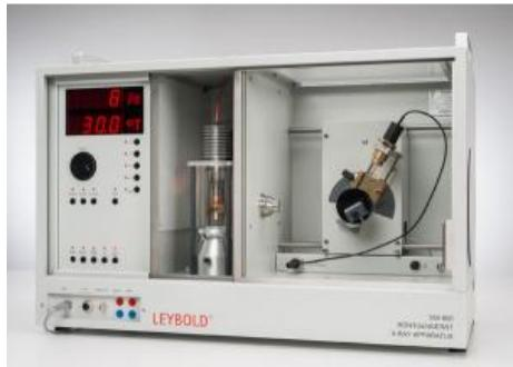
Dans l'expérience P6.3.6.4 on étudie le rayonnement caractéristique de haute énergie de l'anode en argent ainsi que la fission de la structure fine du fait du couplage spin-orbite.
