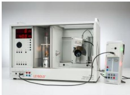
L'objet de l'expérience P6.3.5.1 est l'étude de matériaux connus par analyse à fluorescence X pour calibrer l'axe d'énergie du spectre à l'aide des raies K $\alpha$  et K $\beta$ .
