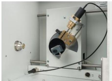
Durant l'expérience P6.3.3.3, on mesure la haute tension U du tube à rayons X en fonction de la longueur donde limite émin du spectre continu du rayonnement de freinage.
