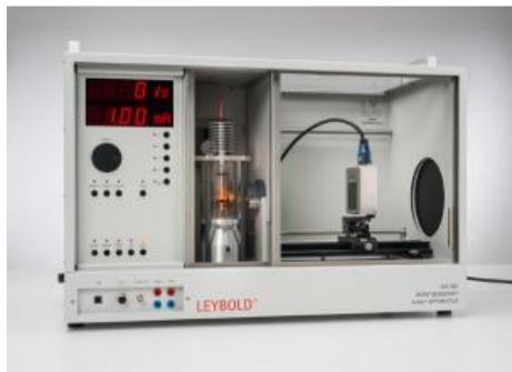
Dans l'expérience P6.3.2.4, il s'agit de mesurer l'intensité du rayonnement X à une distance variable du tube à rayons X.
