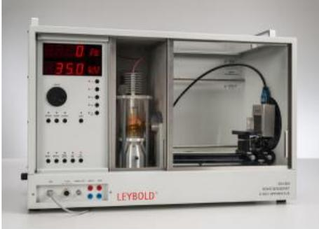
L'expérience P6.3.1.12 mesure l'atténuation des rayons X par l'évaluation quantitative d'une radiographie numérique sur ordinateur, mesure le contraste d'une radiographie numérique en fonction de l'énergie et de l'intensité des rayons X, détermine la résolution des radiographies numériques à l'aide de différentes images test et projette et mesure la tache focale de l'anode du tube à rayons X par une simple image géométrique sur le capteur de radiographie.
