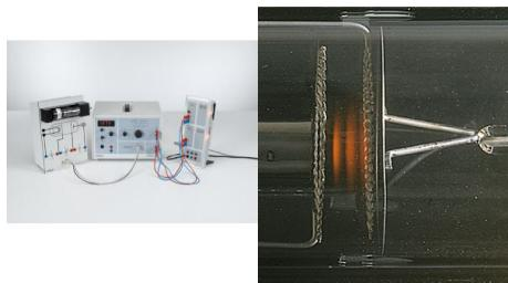
L'expérience de Franck et Hertz avec le néon est proposée en deux variantes, expériences P6.2.4.3 et P6.2.4.4, qui se différencient l'une de l'autre uniquement par le tracé et l'exploitation des données mesurées.
