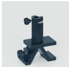
Cavalier pour banc d'optique à profil normalisé.
