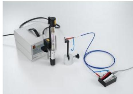
**P6.2.1.4 Observation de la série de Balmer de l'hydrogène avec d'un spectromètre compact**
