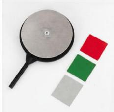
Pour expériences d'optique (l'interférence de Debye-Scherrer, par ex.), illustrant le procédé utilisé dans le tube pour la diffraction d'un faisceau d'électrons par un modèle fonctionnant dans le spectre visible ; avec diaphragme et filtres rouge et vert ; dans monture sur tige.
