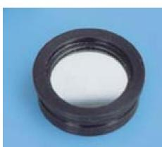
Filtre à bande extrêmement étroite pour la bande spectrale du mercure dans monture.
