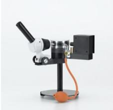
Pour la mise en évidence de la quantification des charges électriques et la définition de la charge élémentaire dispositif compact composé d'un condensateur à plaques sous cache en plastique, d'un microscope de mesure avec angle d'observation oblique, d'un dispositif d'éclairage et d'un atomiseur d'huile ( 685 75 ) avec poire en caoutchouc ( 667 241 ), sur support (trépied) ; livré avec huile dans flacon en plastique ( 685 78 ).
