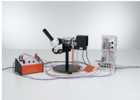
**P6.1.2.4 Détermination de la charge élémentaire électrique selon Millikan et mise en évidence de la quantification de la charge - Mesure de la vitesse d'ascension et de la vitesse de chute avec CASSY**
