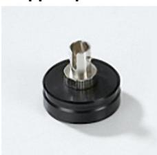
Support pour fibre sans composant optique pour positionner une fibre optique ST dans une monture C25. S'utilise en principe pour procéder à la première étape de l'ajustage de deux collimateurs se faisant face.
