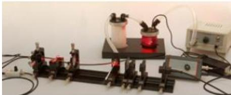
La vélocimétrie laser Doppler est une technique qui permet de mesurer la vitesse sans contact en un point d'un écoulement (fluide, gaz).
