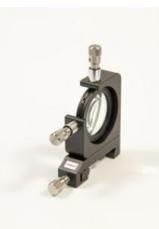
Lentille plan-convexe dans support pour faire converger les deux faisceaux en un point où se forment les franges d'interférence avec un dispositif de vélocimétrie laser à effet Doppler VLD (ou anométrie laser Doppler). La lentille est déplaçable sur deux axes à des fins d'ajustage.
