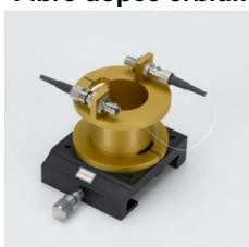
Fibre optique monomode dopée aux ions erbium.
