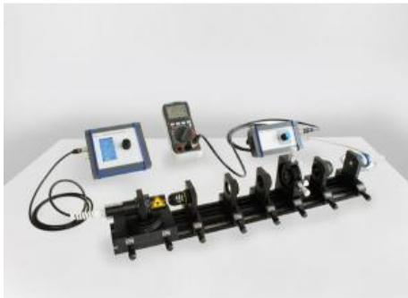
Le but de l'expérience P5.8.6.1 est d'étudier les propriétés d'une diode laser, à savoir ses paramètres caractéristiques comme la puissance et la longueur d'onde d'émission en fonction de la température. Dans une prochaine étape, on mesure la répartition spatiale de l'intensité. À l'aide de deux lentilles cylindriques, on convertit le faisceau de forme plus ou moins elliptique en un faisceau presque circulaire.
