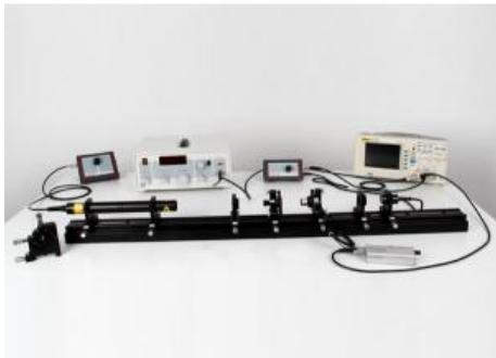
Un interféromètre de Fabry Perot est constitué de deux miroirs parallèles qui se font face. La qualité cristalline de la cavité résonnante ainsi formée varie si la distance qui sépare les miroirs est modifiée d'un multiple de la demi-longueur d'onde.
