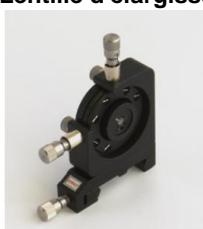
Lentille biconcave à courte focale ( $f = -5 \text{ mm}$ ) dans support ajustable, pour élargir un faisceau laser.
