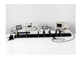
Un interféromètre de Fabry Perot est constitué de deux miroirs parallèles qui se font face. La qualité cristalline de la cavité résonnante ainsi formée varie si la distance qui sépare les miroirs est modifiée d'un multiple de la demi-longueur d'onde.
