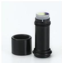
Miroir laser pour la réalisation d'un étalon de Fabry-Pérot, à monter dans le support ajustable 474113 .
