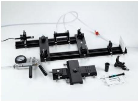
Alors que l'interféromètre de Michelson est essentiellement utilisé pour déterminer le déplacement d'un élément réfléchissant à l'échelle nanométrique, l'interféromètre de Mach-Zehnder analyse des objets transparents et est particulièrement utile pour étudier la dynamique des fluides et des gaz.
