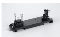
Traverse permettant de relier deux bancs d'optique parallèles. Pour la réalisation d'interféromètres, notamment de Mach-Zehnder.
