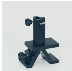
Cavalier pour banc d'optique à profil normalisé.
