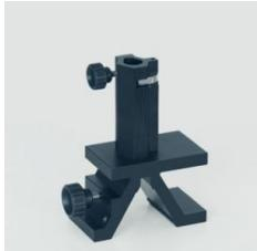
Cavalier pour banc d'optique à profil normalisé.
