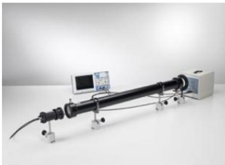
Dans l'expérience P5.6.3.2, on détermine la vitesse de la lumière dans divers milieux de propagation.
