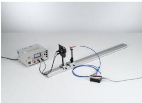
Dans l'expérience P5.5.2.4, un conducteur électrique d'une lampe à incandescence est chauffé à l'aide du courant électrique jusqu'à incandescence.
