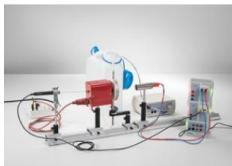
Dans les expériences P5.5.2.1 et P5.5.2.2, on se sert comme corps noir d'un four muni d'un cylindre en laiton bruni. On chauffe ce cylindre dans le four à la température désirée pouvant varier de 300 à 750 K.
