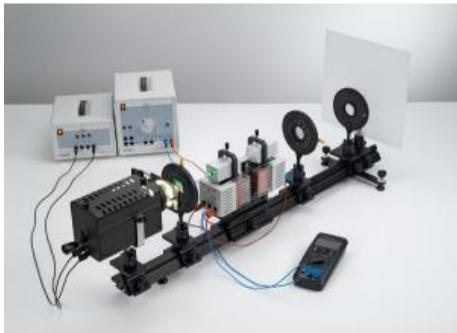
Dans l'expérience P5.4.6.1, on calibre tout d'abord le champ magnétique à l'aide d'une sonde champ magnétique en fonction de l'intensité du courant qui traverse les électroaimants; l'effet Faraday est alors étudié sur un parallélépipède en flint.
