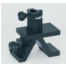
Cavalier pour banc d'optique à profil normalisé.
