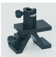
Cavalier pour banc d'optique à profil normalisé.
