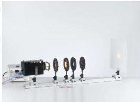
Dans l'expérience P5.4.3.1, on étudie l'activité optique d'un cristal portant le nom de quartz. Selon sa direction par rapport à son axe optique, le quartz est dextrogyre ou lévogyre. L'angle de rotation dépend fortement de la longueur d'onde de la lumière, raison pour laquelle on utilise un filtre de couleur jaune.
