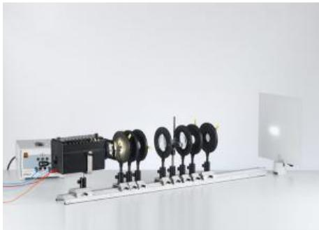
Dans l'expérience P5.4.2.3, on détermine la valeur et la direction des déformations dans des modèles en plastique transparents.
