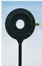
Pour la rotation du plan de polarisation de la lumière polarisée linéairement. Film biréfringent (film de retardement) d'épaisseur appropriée dans monture pivotante, sur tige.
