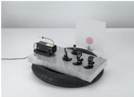
L'expérience P5.3.5.3 consiste à disposer les composants les uns derrière les autres sur la plaque de base pour laser de manière à réaliser un interféromètre de Fabry-Perot avec deux miroirs parallèles.
