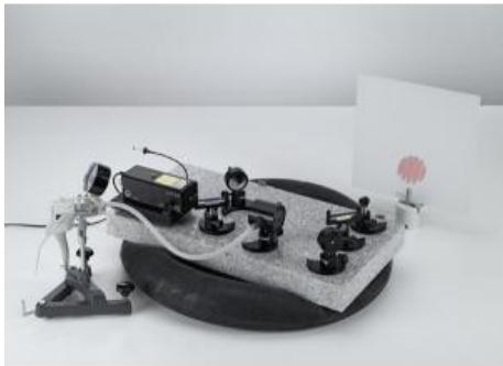
Dans l'expérience P5.3.5.2, on détermine l'indice de réfraction de l'air.
