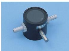
En interférométrie, pour la détermination de l'indice de réfraction des gaz. Fournie avec deux raccords de tuyaux et des bouchons en caoutchouc. Sur tige.
