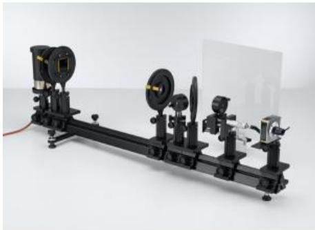
L'expérience P5.3.4.6 se consacre à la détermination de la longueur d'onde  $\lambda$  et la scission des lignes  $\lambda$  du doublet jaune d'une lampe à vapeur de mercure.
