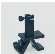
Cavalier pour banc d'optique à profil normalisé.
