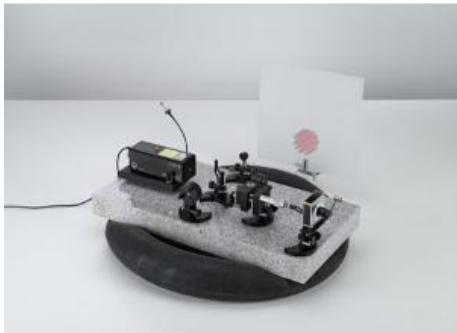
Dans l'expérience P5.3.4.2, la longueur d'onde d'un laser He-Ne est déterminée après le changement de la figure d'interférence en déplaçant le miroir de l'interféromètre et le déplacement du miroir.
