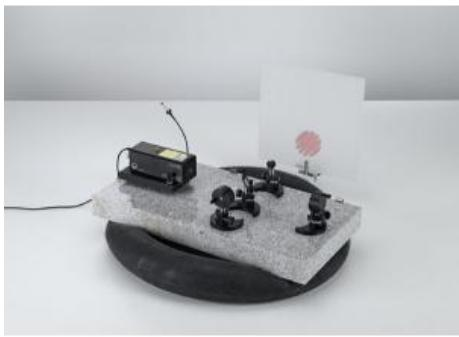
Dans l'expérience P5.3.4.1, on monte l'interféromètre de Michelson sur une plaque de base pour optique laser insensible aux secousses.
