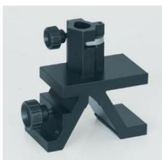
Cavalier pour banc d'optique à profil normalisé.
