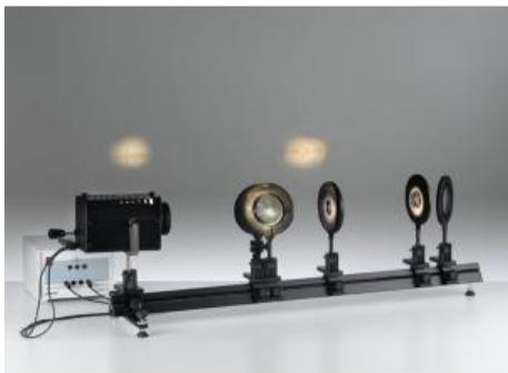
Dans l'expérience P5.3.3.2, les anneaux de Newton sont étudiés aussi bien par réflexion que par transmission. Étant donné que les sous-faisceaux lumineux subissent dans le coin d'air un saut de phase de  $\pi/2$  à chaque réflexion sur les surfaces de verre, les conditions d'interférence pour la réflexion et pour la transmission sont complémentaires.
