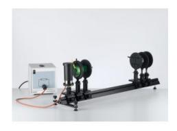
Dans l'expérience P5.3.1.9, on étudie la condition de cohérence. On utilise ici comme source lumineuse une fente simple réglable illuminée par une lampe spectrale à mercure (Hg).
