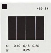
Diaphragmes pour expériences sur la diffraction, réalisés par technique photographique, en cadre de diapositive, différentes largeurs de fentes.
