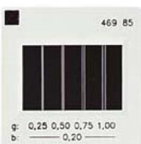
Diaphragmes pour expériences sur la diffraction, réalisés par technique photographique, en cadre de diapositive, différentes largeurs de fentes.
