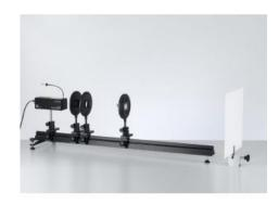
Dans l'expérience P5.3.1.3, on étudie la diffraction par un réseau à traits et par deux réseaux croisés. Ces deux réseaux forment entre eux un angle de 90°.
