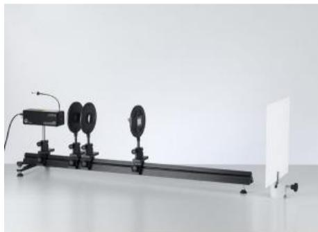
Dans l'expérience P5.3.1.3, on étudie la diffraction par un réseau à traits et par deux réseaux croisés. Ces deux réseaux forment entre eux un angle de 90°. Les maxima de diffraction sont des points situés aux points d'intersection d'un réseau linéaire et quadratique.
