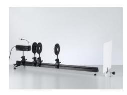
Dans l'expérience P5.3.1.2, on considère la diffraction par une fente double.
