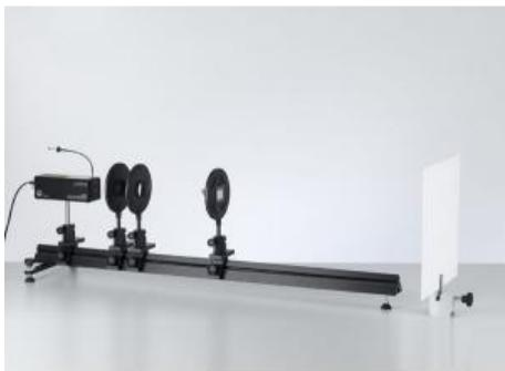
Dans l'expérience P5.3.1.1, on étudie les minima dintensité de diffraction par une fente. Pour une fente de largeur  $b$ , l'angle de diffraction  $k$  par rapport à l'axe optique est donné par:
