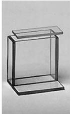
Pour effectuer des mesures dans le domaine de l'optique, telles que l'absorption ou l'extinction ainsi que pour la projection de phénomènes dans des liquides. Résistante à tous types de liquides, à l'exception des acides qui attaquent le verre, tels que l'acide fluorhydrique. Avec fond à bords saillants.
