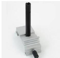
Support pour composants optiques à tige de 8 mm de diamètre.
