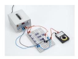
Dans l'expérience P4.2.2.4, on démontre laddition ou la soustraction de plusieurs signaux dentrée.
